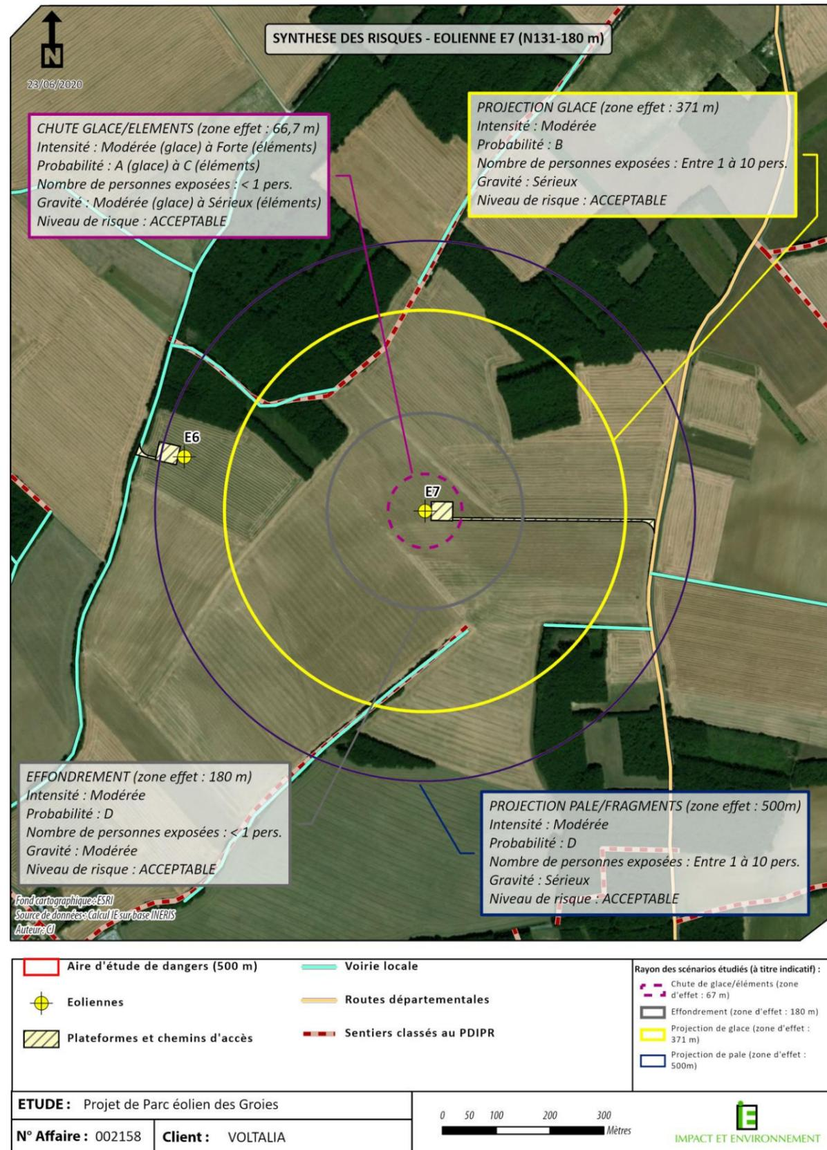
Figure 16 : Synthèse des risques - Eolienne E7
